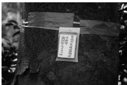
図3 設置に際してのデータロガーの防水の様子。プラスチックケースの縁をガムテープで固定する。
