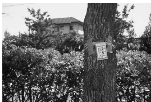
図4 データロガーの設置風景。樹木の木陰などに地上約150cmの高さになるようにビニール紐とガムテープで固定した。
