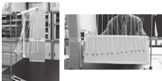
図6：ナットで作ったペンデュラムウェーブ
