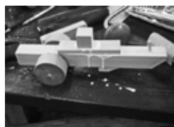
図31. ボンドの使用(付け過ぎ)
